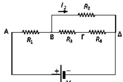
55. Για το διπλανό κύκλωμα δίνεται ότι  $R_1 = 2\Omega$ ,  $R_2 = 3\Omega$ ,  $R_3 = 1\Omega$  και  $V = 24V$ .
