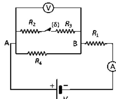
56. Για το κύκλωμα του διπλανού σχήματος δίνονται  $R_1 = 2\Omega$ ,  $R_2 = 3\Omega$ ,  $R_3 = 20\Omega$ ,  $R_4 = 1\Omega$  και  $V = 25V$ . Na upoloγίσετε:
